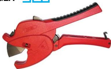
Tipo brevettato super-professionale a cesoia, con movimento a cricco e profilo della lama speciale, in acciaio INOX rivestita in PTFE, per un agevole taglio di ogni tipo di tubo in PVC, PE, PP, PB, VPE, PVDF, PEX, MLP, MSR, CPVC, multistrato fino a 0,6 mm di spessore, nylon, gomma e vinile, ecc. Lama a cambio rapido, protetta, per evitare incidenti durante il taglio. Corpo in speciale lega al magnesio, leggero e robusto, con impugnatura rivestita in morbida gomma antiscivolo.
